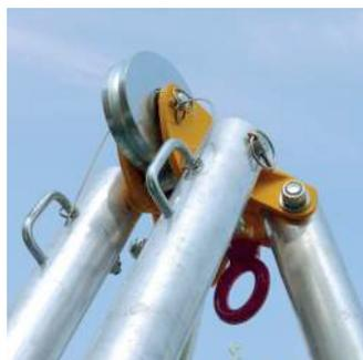
△ Poulie facilement démontable pour éviter le démontage des pieds lors du passage du câble avant chaque utilisation.
