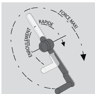
△ Manivelle amovible. Bras réglable pour enroulement rapide ou, au contraire, force maximale.
