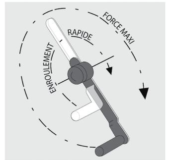
△ Manivelle amovible. Bras réglable pour enroulement rapide ou, au contraire, force maximale.
