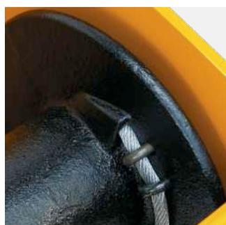
△ Attache-câble très sûr sans outil spécial avec guidage de bon enroulement du câble.
