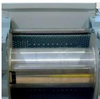
▶ Tambour protégé par une tôle orientable perforée. Larges flasques pour une grande capacité de câble.
