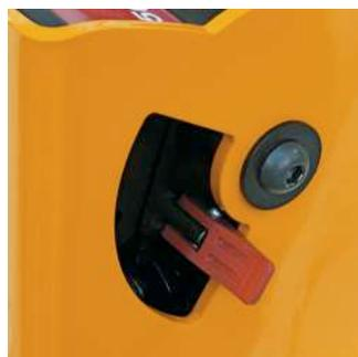
△ Débrayage impossible en charge (sauf VS 250/320 sans débrayage).
