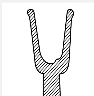
Un enroulement sur le tambour trop serré ou des chevauchements.
