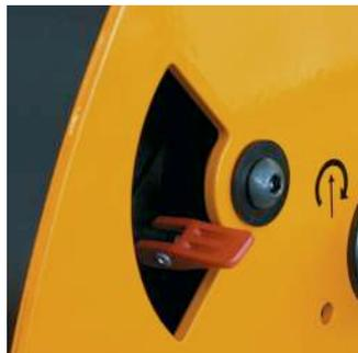
△ Débrayage impossible en charge.
