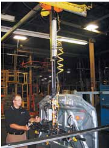
Torque tube avec dispositif de manutention par dépression intégré
