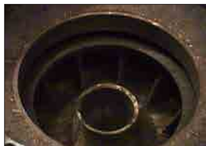
Erosion et corrosion de la pompe après 5 ans de service dans l'eau de la rivière
