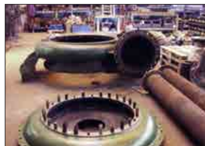
Après 10 ans de service, le revêtement ARC 855 ne montre aucun signe d'endommagement
