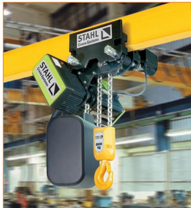
1 Le chariot-treuil court: cette construction brevetée réduit la hauteur perdue d'environ 33 % et permet des hauteurs de levage exceptionnellement grandes, surtout dans des ateliers bas.
