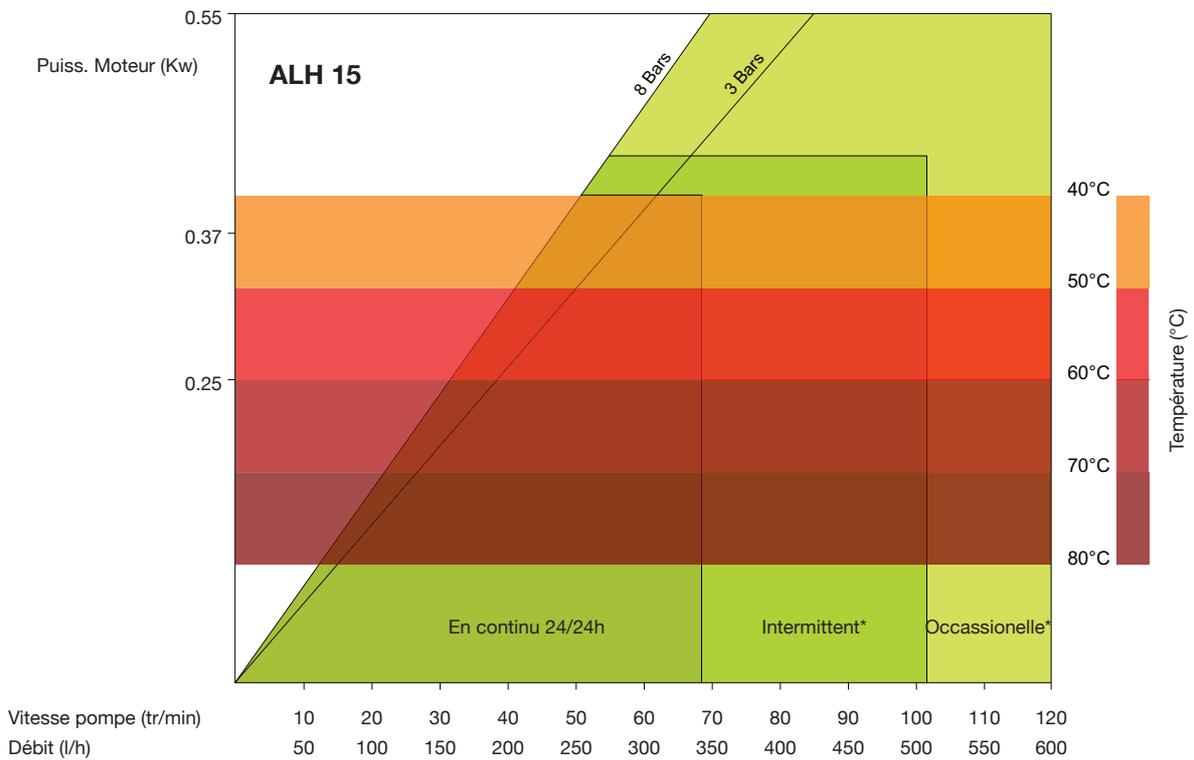
\*Utilisation intermittente : minimum d'une heure d'arrêt après 2 heures de fonctionnement.
