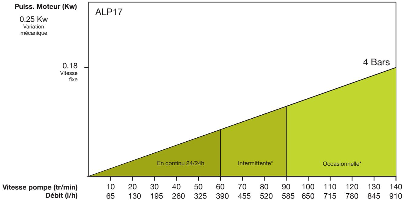
\*Utilisation intermittente : minimum d'une heure d'arrêt après 2 heures de fonctionnement.
