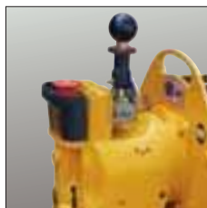
Arrêt d'urgence (en standard sur versions CE)
